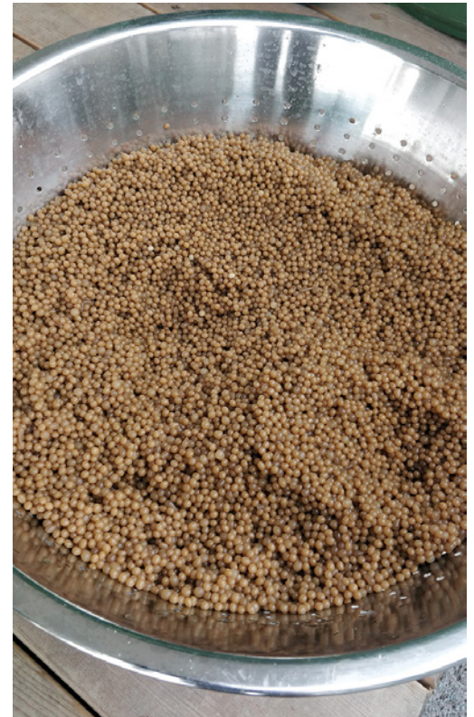
I microrganismi immobilizzati e non OGM sono contenuti in un tipo di letto fisso attraverso il quale passa il succo./ Immobilized, non-GMO microorganisms are contained in a type of fixed bed through which the juice passes.
